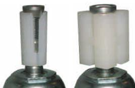
Die oben abgebildeten Rückenloch - Rollen sind mit Sprezhülsenbefestigungen für Rundrohre von Rohrinne Durchmesser 14 mm bis 31 mm und für Vierkantröhre von Rohrinne Durchmesser 17x17 mm bis 35x35 mm lieferbar.
