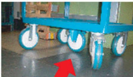
**4 Lenkrollen und 1 gefederte Bockrolle im Drehpunkt**
